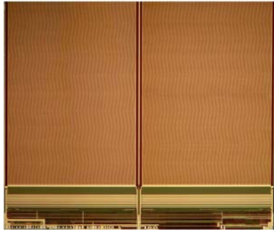
128 Gbit NAND 19nm San Disk/Toshiba 2012
